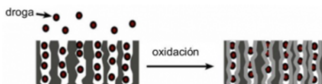
Figura 3: Una partícula de droga puede quedar atrapada al oxidar el silicio poroso. La oxidación produce una expansión que reduce los poros encerrando a la partícula.
