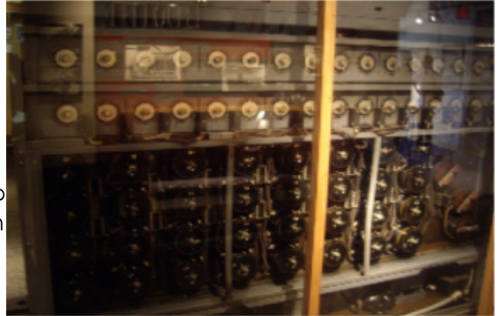
Máquina electromecánica llamada Bomb, ideada por Turing para vulnerar Enigma (exhibida en el museo nacional de Criptología de Washington D.C, EUA)
