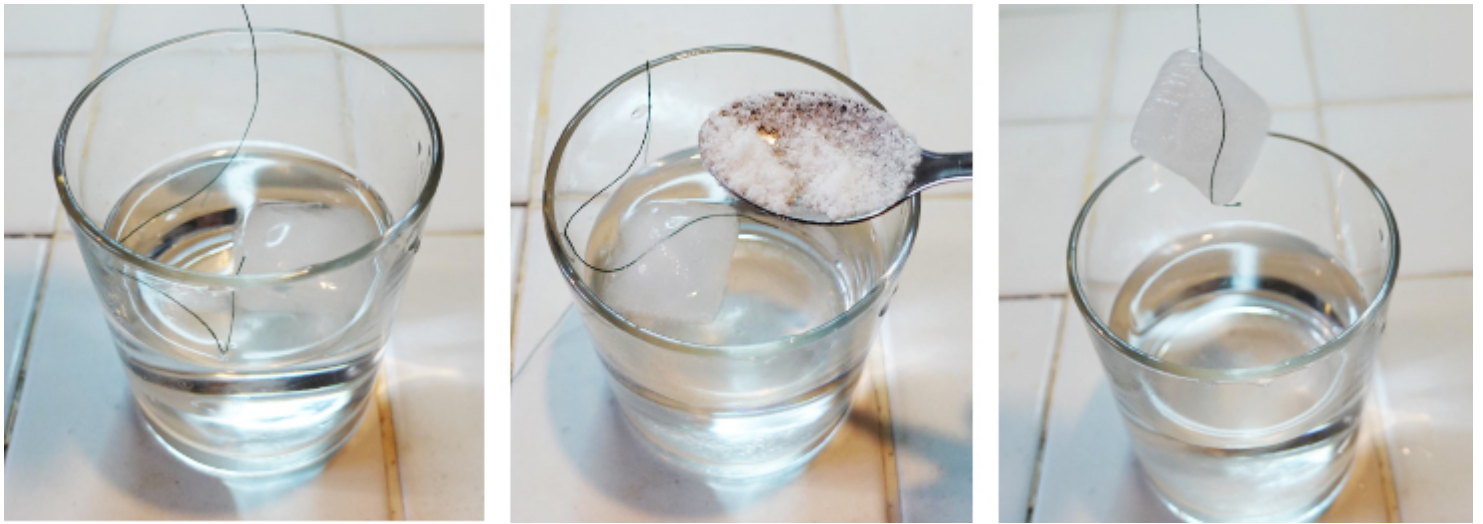
Figura 6. Captura del cubo de hielo con hilo de coser. Mojar el hilo y ponerlo encima del cubo, a continuación espolvorear con sal. Después de un minuto, se puede levantar. Por último, como virtuosismo supremo, vemos que podemos intercambiar el contenido de un vaso que contiene agua y uno que contiene vino, sin necesidad de utilizar un tercer recipiente. Conviene utilizar vasos pequeños, como los de licor, que deben ser llenados hasta el borde.
