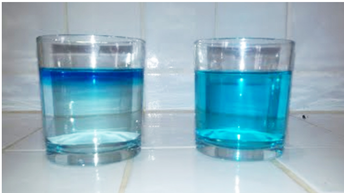
Figura 5. Un vaso con agua salada a la izquierda, y con agua dulce a la derecha. En el caso con sal el agua coloreada de la fusión del cubito de hielo flota sobre el agua salada.
